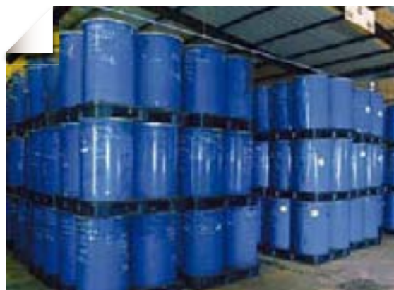
Déchets radifères conditionnés en fûts
