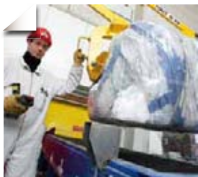
Déchets TFA compactés
