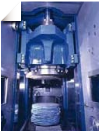
Compactage d'un fût de déchets FMA-VC
