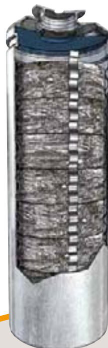
Débris métalliques issus des structures entourant les combustibles usés (coques et embouts)
