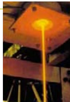
Vitrification de déchets HA
