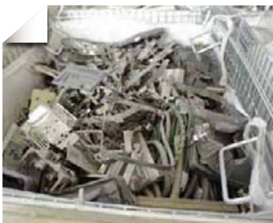
Déchets industriels TFA (ferrailles, plastiques...) avant conditionnement
