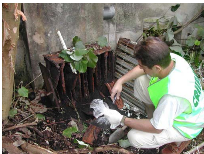
T3 / N°82 : échantillonnage du charbon actif destiné à épurer l'air des iodes radioactifs avant insufflation dans le hangar destiné à la protection des populations lors des retombées radioactives à Rikitea (Mangareva). CRIIRAD, le 7 octobre 2005.
