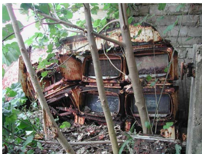
T3 / N°83 : caissons à charbon actif et caissons à filtres Millipore destinés à épurer l'air des iodes et aérosols radioactifs avant insufflation dans le hangar destiné à la protection des populations lors des retombées radioactives à Rikitea (Mangareva). CRIIRAD, le 7 octobre 2005.
