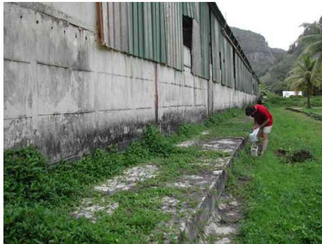
T3 / N°47 : contrôles radiométriques le long de l'ancien caniveau de récupération des eaux de lavage de la façade ouest du toit du hangar destiné à protéger la population à Rikitea (Mangareva). CRIIRAD, le 7 octobre 2005.
