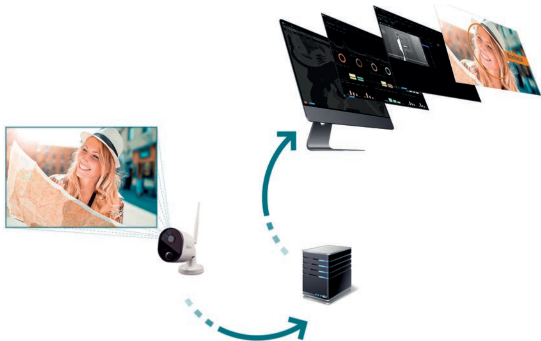
Schématisme du processus d'analyse vidéo sur serveur
