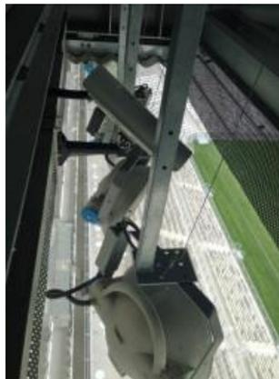
Système de 14 caméras (7 par but) grandes vitesses qui permet de détecter le franchissement du ballon de la ligne de but.
