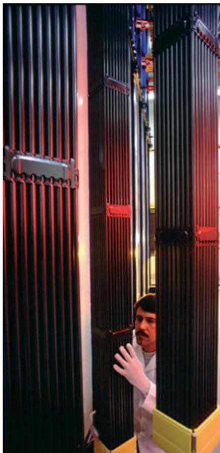
4. Assemblage de combustible nucléaire d'un réacteur à eau pressurisée comprenant une barre de contrôle. Les grilles assurent le maintien mécanique des 264 crayons combustibles en place.
